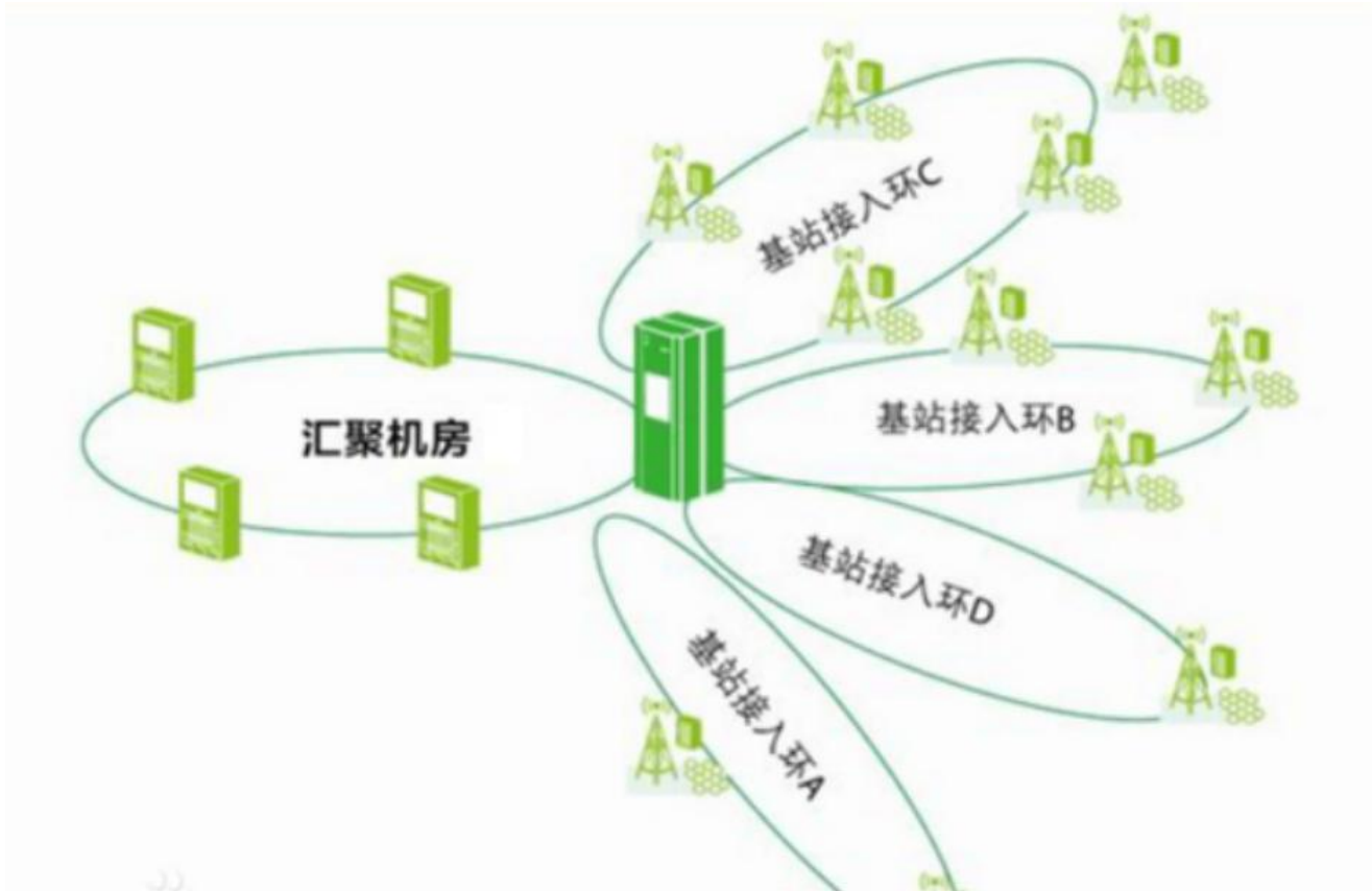
图 5-1：5G 汇聚机房网络拓扑示意图
