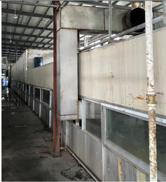
浸胶手套生产线（密闭生产线）
