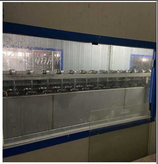
浸胶手套生产水洗工序（密闭空间）
