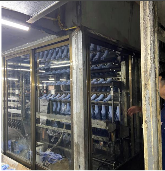
浸胶手套浸胶工序（密闭空间）
