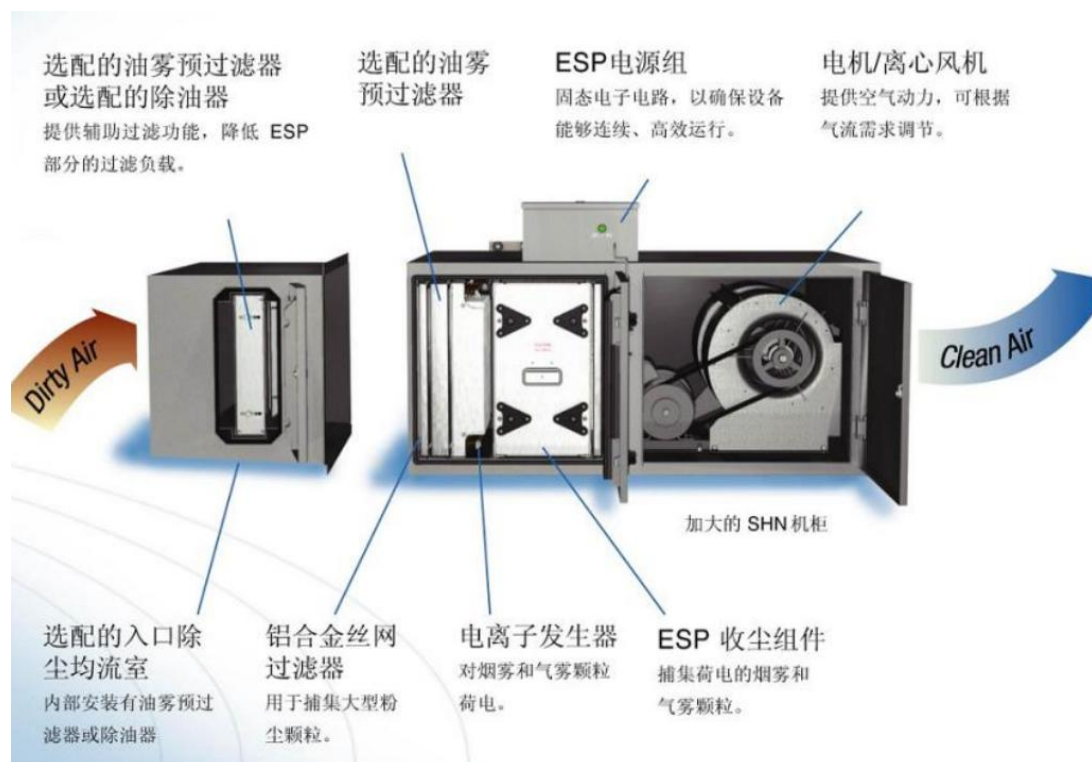
图 6.2-7 高压静电除油装置结构示意图
